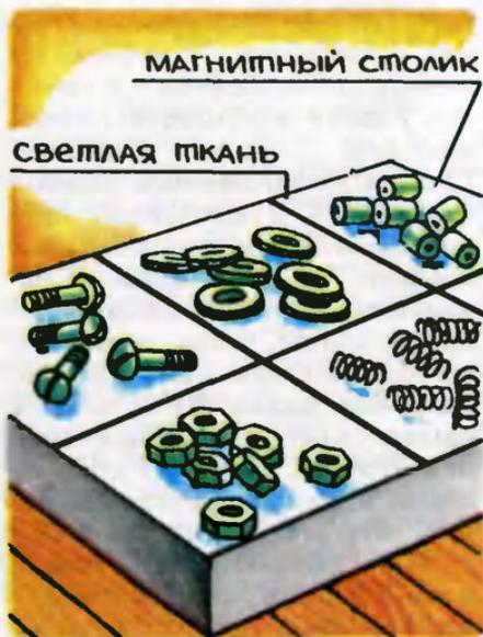
крепежные детали — гайки, шайбы, болты, пружинки, прокладки, — необходимые для работы. Поверхность столика даже можно расчертить пинями на отдельные участки для каждого вида деталей. Загрязненную ткань ничего не стоит заменить.
