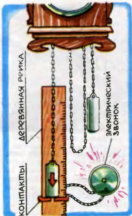
рейку с сантиметровыми делениями и тщательно измерил путь, который гиря проходит за час. Простой зажим крепит в любом месте рейки пару контактных пластин; когда гиря доходит до них — замыкается цепь из батарейки и электрического звонка.
