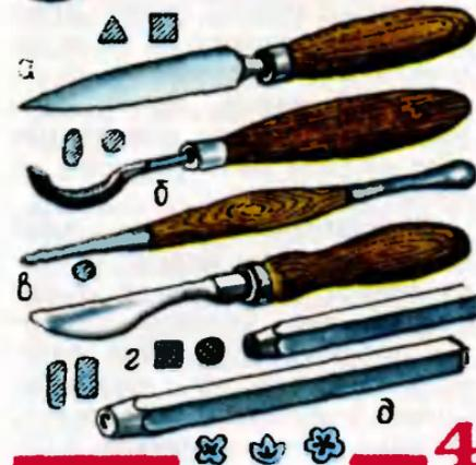
няется для самых разнообразных граверных работ. Им размечают рисунок, прорезают контуры изображения, подрезают остроугольные элементы гравировки. Шпицштихель используют также для выполнения на металле различных надписей каллиграфическим шрифтом. Углубляя или выводя ближе к поверхности кончик реза, регулируют ширину прорезаемой канавки. Но наиболее широкие линии получают при гравировании боковой поверхностью штихеля.
